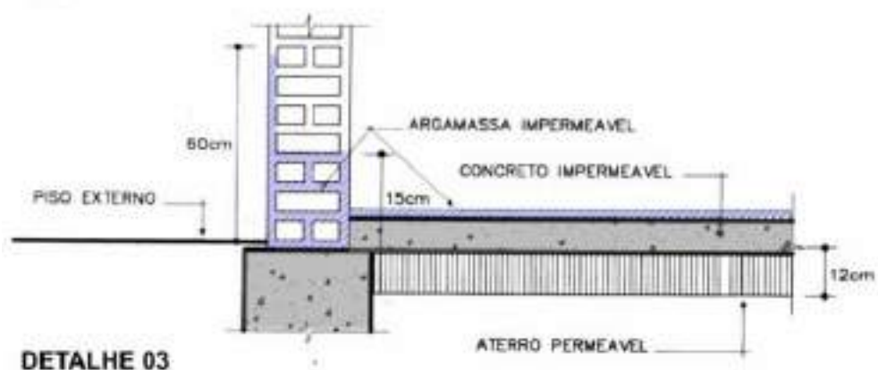
Figura 5: Detalhe 3 da impermeabilização do embasamento
