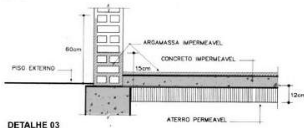
Figura 3: Detalhe da impermeabilização do embasamento
