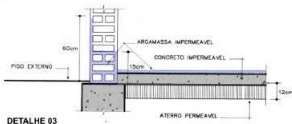
Figura 3: Detalhe da impermeabilização do embasamento
