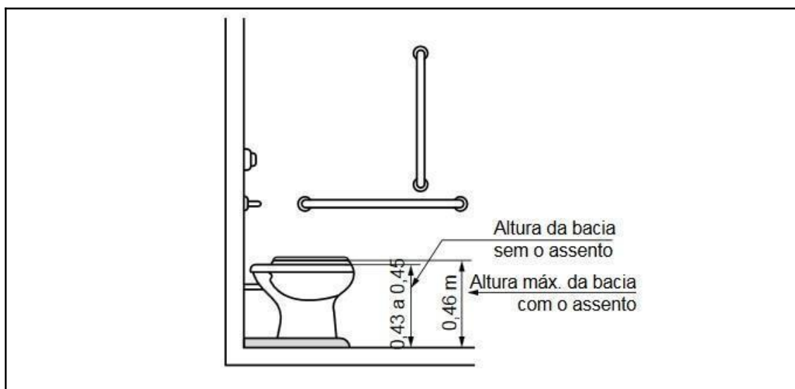
Figura 17: Detalhe da NBR 9050 – Altura da bacia – vista lateral.
