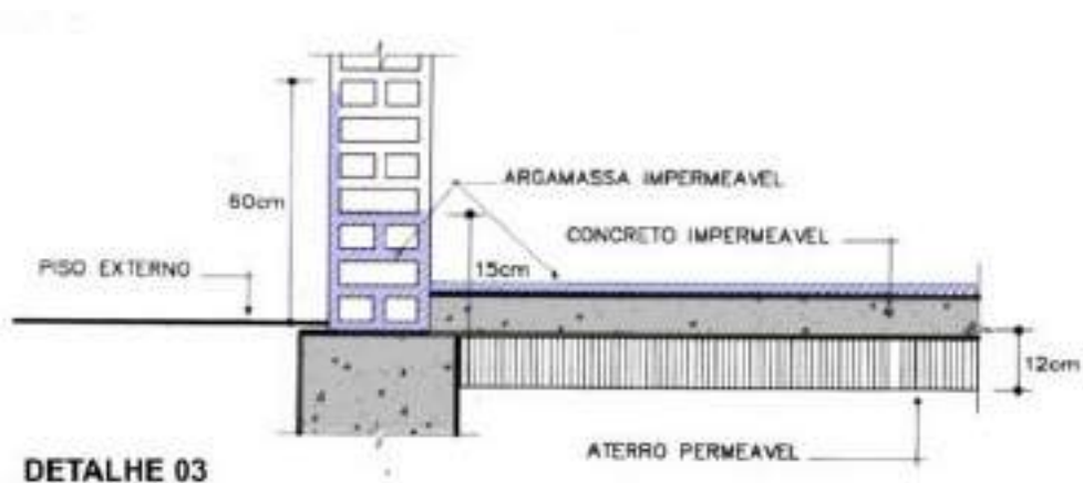
Figura 3: Detalhe 3 da impermeabilização do embasamento
