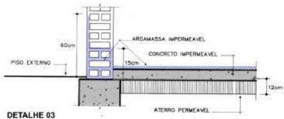
Figura 3: Detalhe 3 da impermeabilização do embasamento
