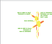
Detalhe D - Conexão entre o subsistema de aterramento (cabo de cobre nu) e haste de aterramento
