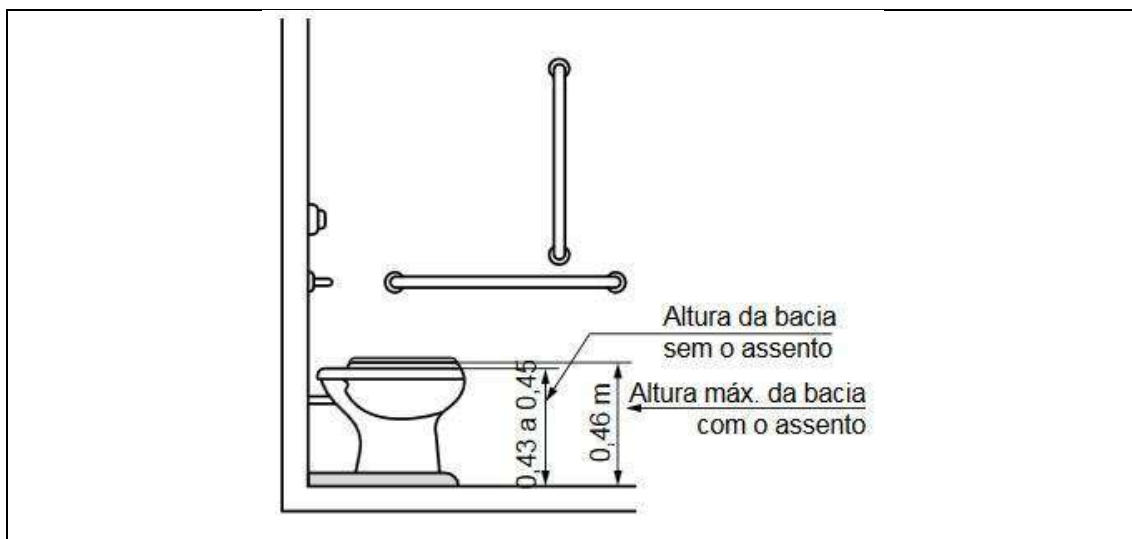
Figura 17: Detalhe da NBR 9050 – Altura da bacia – vista lateral.
