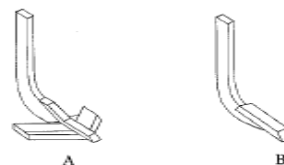
FIGURA 28 - Formatos de ponteiros de subsolador: A) larga; B) estreita.
