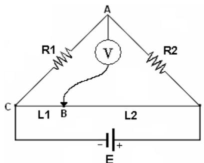
Sendo o valor de  $R1 = 25k\Omega$ , o valor de  $R2 = 15k\Omega$  e o comprimento  $L2$  sendo 30 cm, a ponte estará em equilíbrio quando o comprimento de  $L1$  for igual a:
