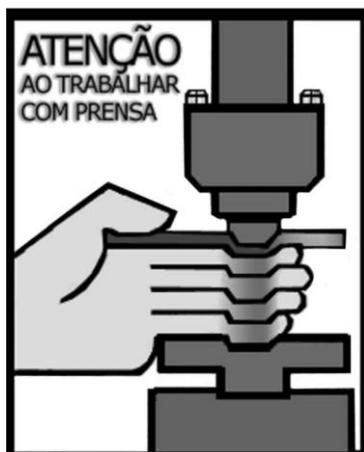
**O cartaz mostra a mão do trabalhador sendo prensada. A máquina, desprotegida, permite o**
