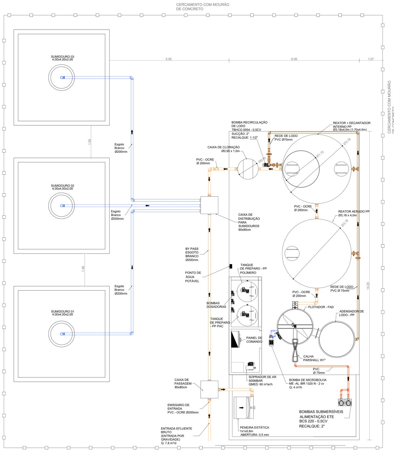
**PLANTA BAIXA - ESTAÇÃO DE TRATAMENTO DE ESGOTO (PARTE HIDRAULICA)**
