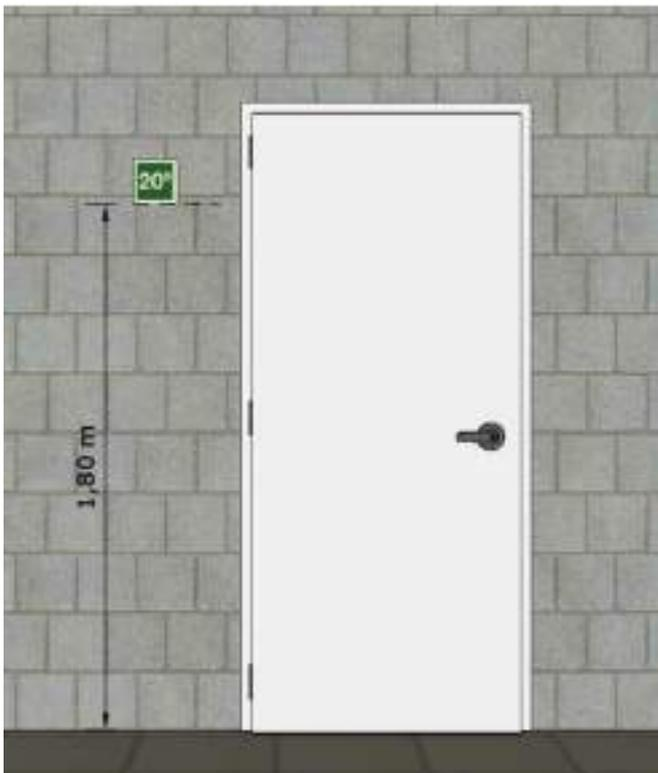
Figura 14: Sinalização de identificação do pavimento.
