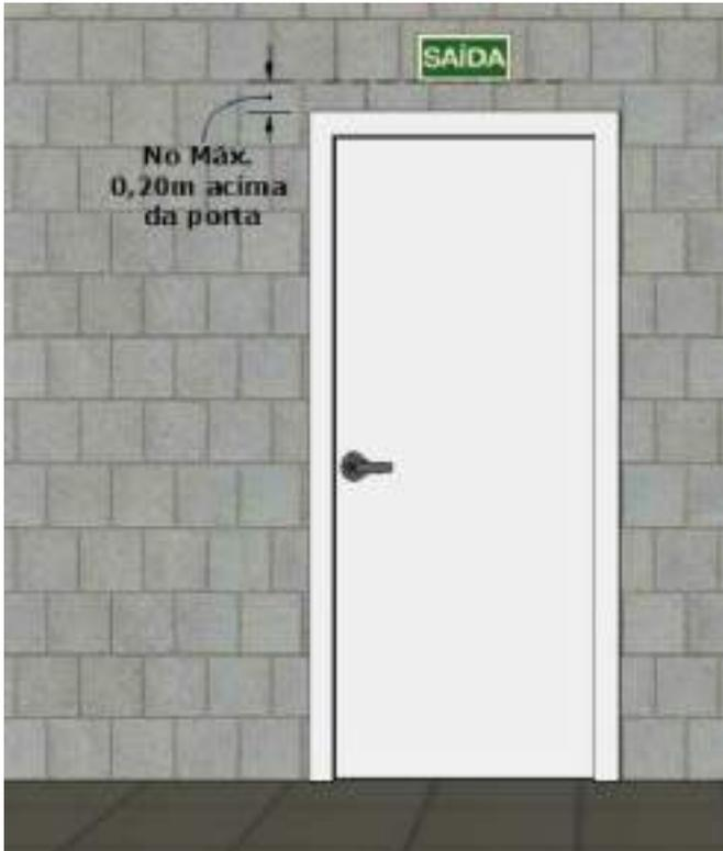
Figura 13: Saída de Emergência.
