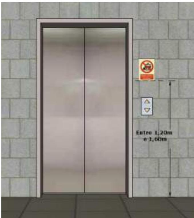
Figura 18: Sinalização básica de proibido utilizar elevador em caso de incêndio.
