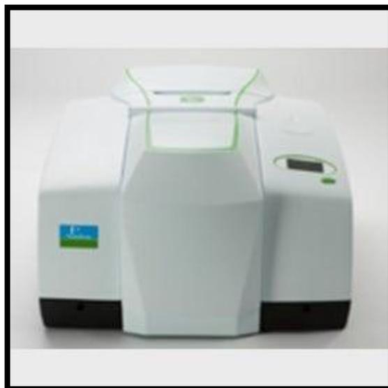
**Figura 4:** Equipamento de Espectroscopia de Infravermelho- Perkin Elmer Frontier.
