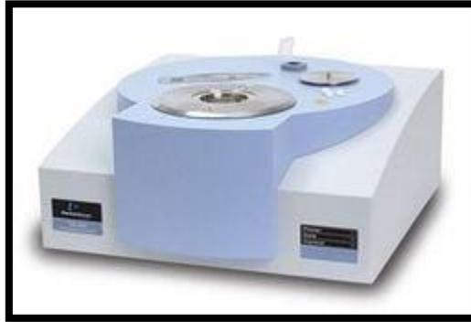
**Figura 2:** Equipamento de TGA- Perkin Elmer
