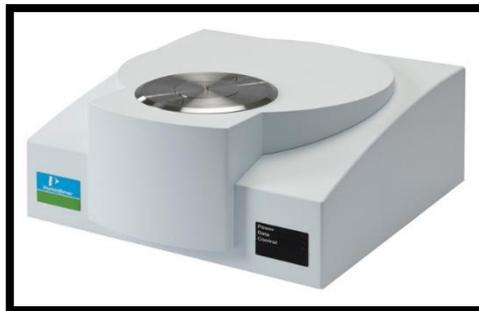
**Figura 1:** Equipamento de DSC- Perkin Elmer 4000.
