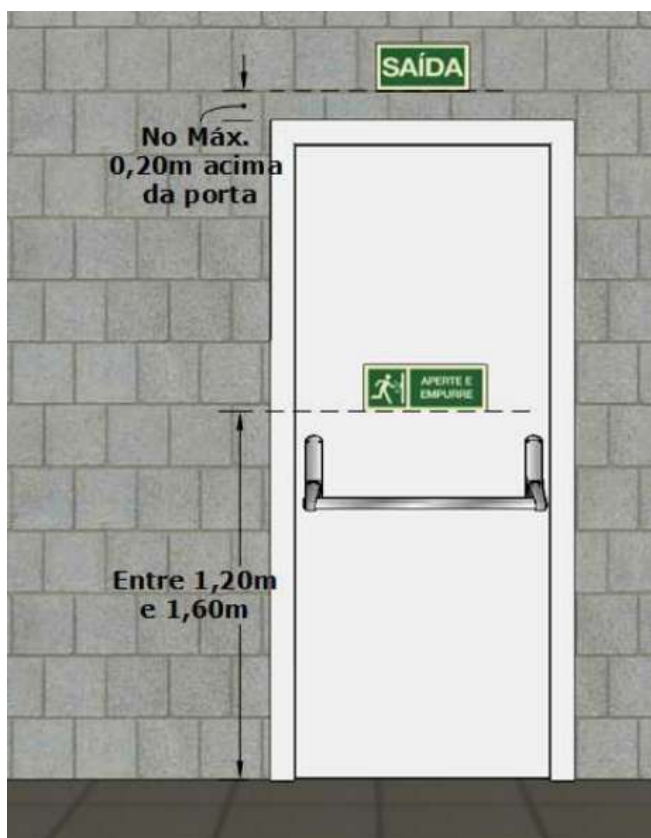
Figura 15: Sinalização de porta de saída de emergência com barra antipânico.
