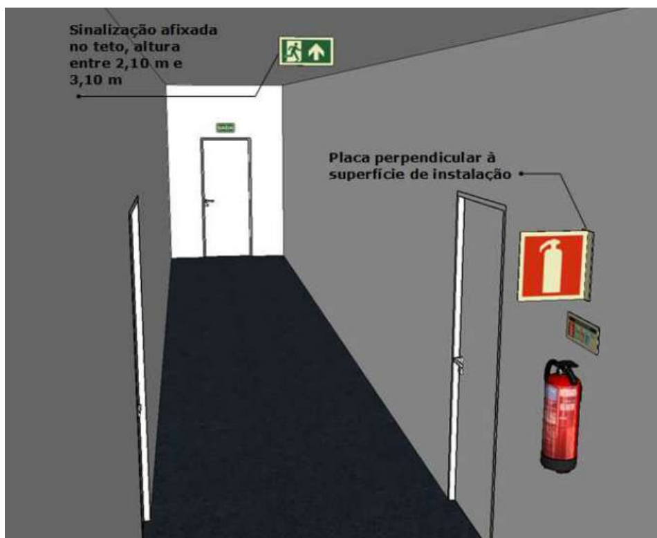
Figura 17: Sinalização básica de rota de fuga e de extintor de incêndio instalada em corredor.
