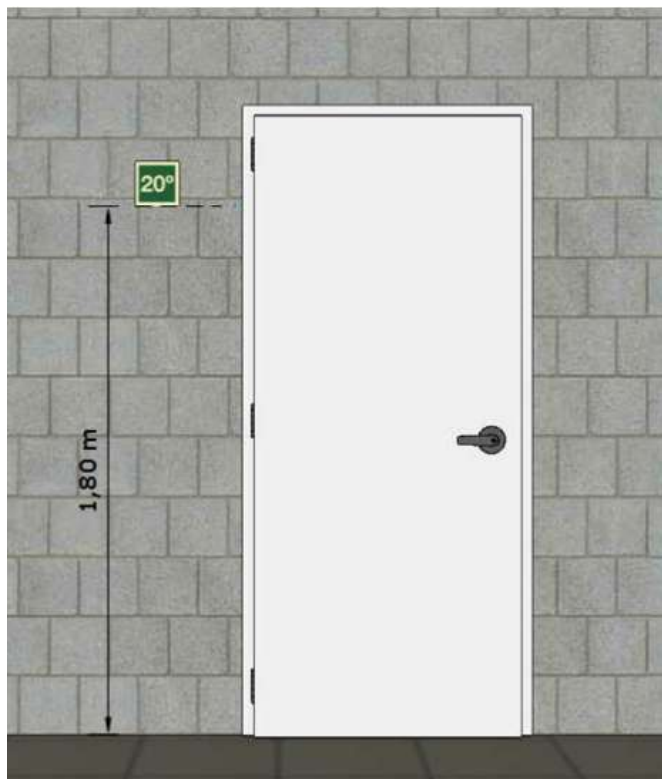
Figura 14: Sinalização de identificação do pavimento.
