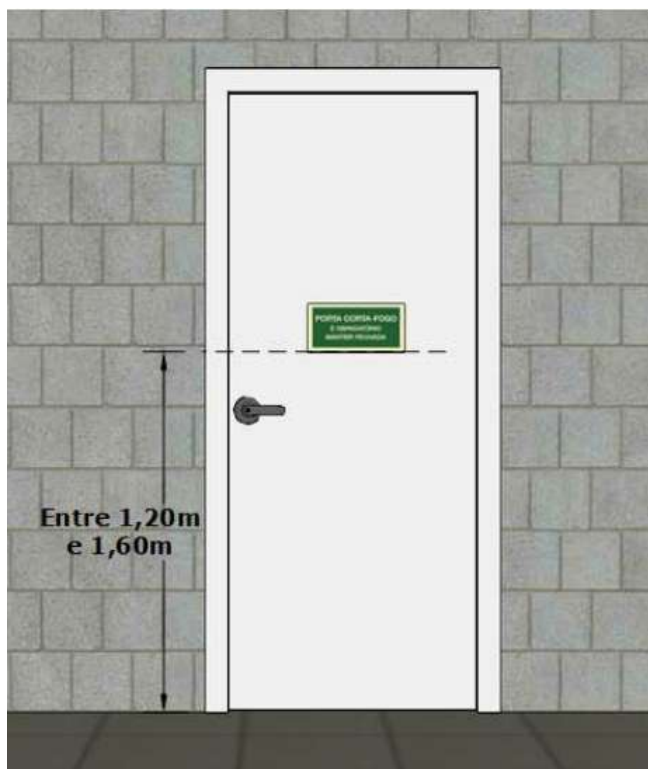
Figura 16: Sinalização de porta corta-fogo mantida fechada, porém destrancada.
