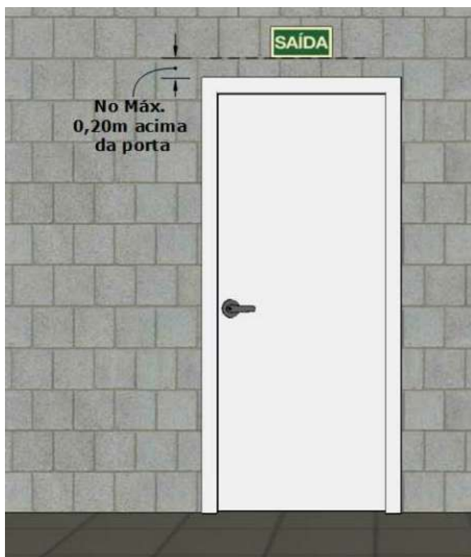
Figura 13: Saída de Emergência.
