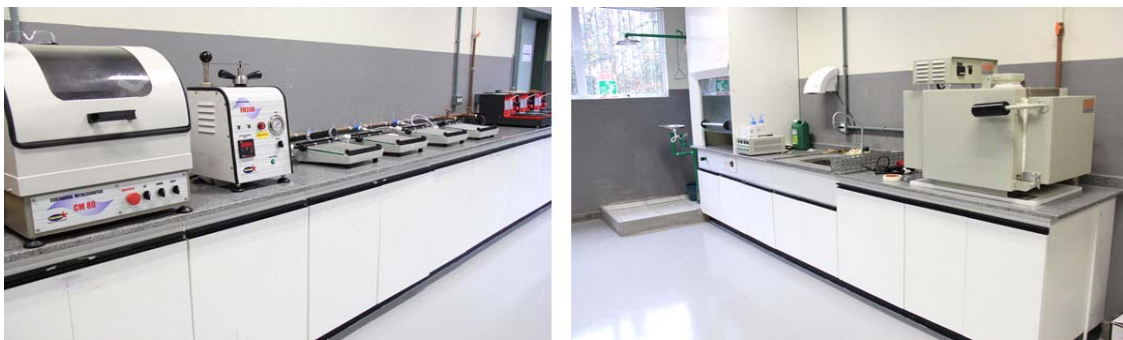
Figura 8 – Equipamentos para metalografia e tratamentos térmicos (cortadeira, embutidora, lixadeiras manuais, poltrizes, capela para ataque químico, forno mufla).
