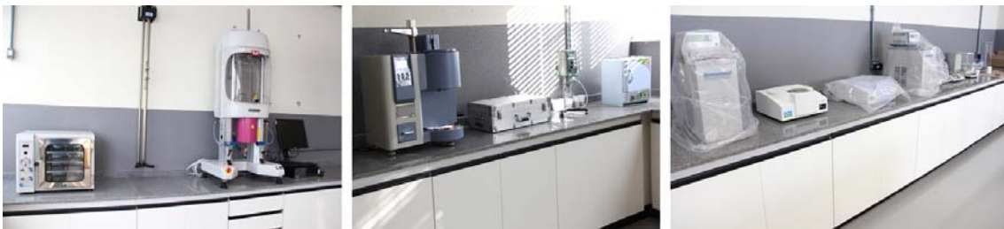
Figura 3 – Equipamentos para análise e caracterização de polímeros (estufa a vácuo, reômetro capilar, plastômero de extrusão, viscosímetro rotacional, calorímetro diferencial de varredura, analisador termogravimétrico, espectrofotômetro de infravermelho, máquina de ensaios universal 20 kN, reômetro oscilatório).
